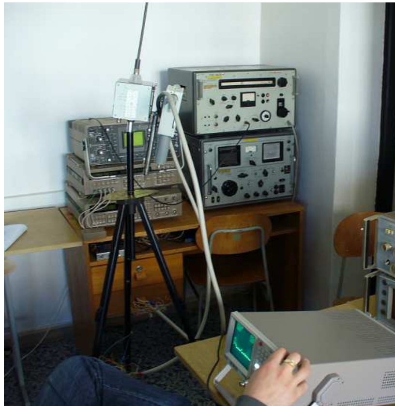
Príloha 2. Snímky merania vyžarovania z a do kábla na EF Žilinskej univerzity v Žiline
